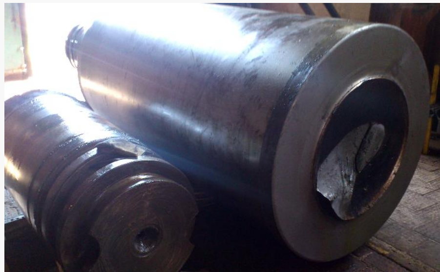
Разрушенный валок прокатного стана, ОАО «Алкоа Металлург Рус»
