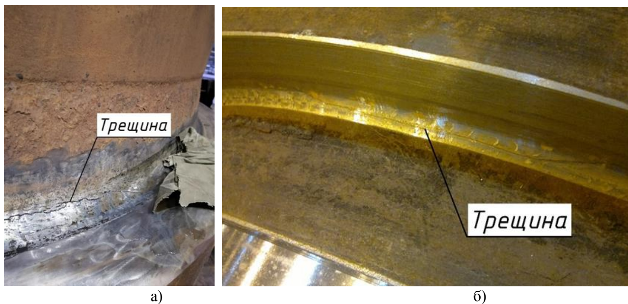
Рисунок 4. Фотографии трещин в радиусных скруглениях фланцев главных рабочих цилиндров а) цилиндр прессы Škoda б) цилиндр прессы УЗТМ
