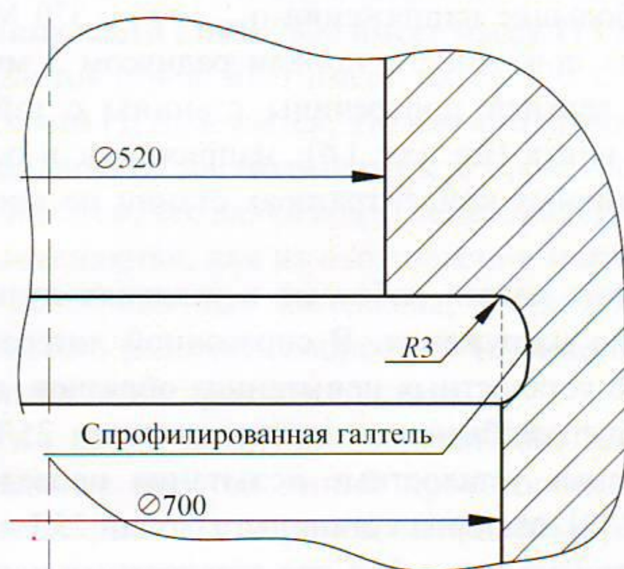
Рис. 7. Конструкция галтельного перехода с заглублением в вертикальную стенку отверстия для установки гайки нажимного винта
