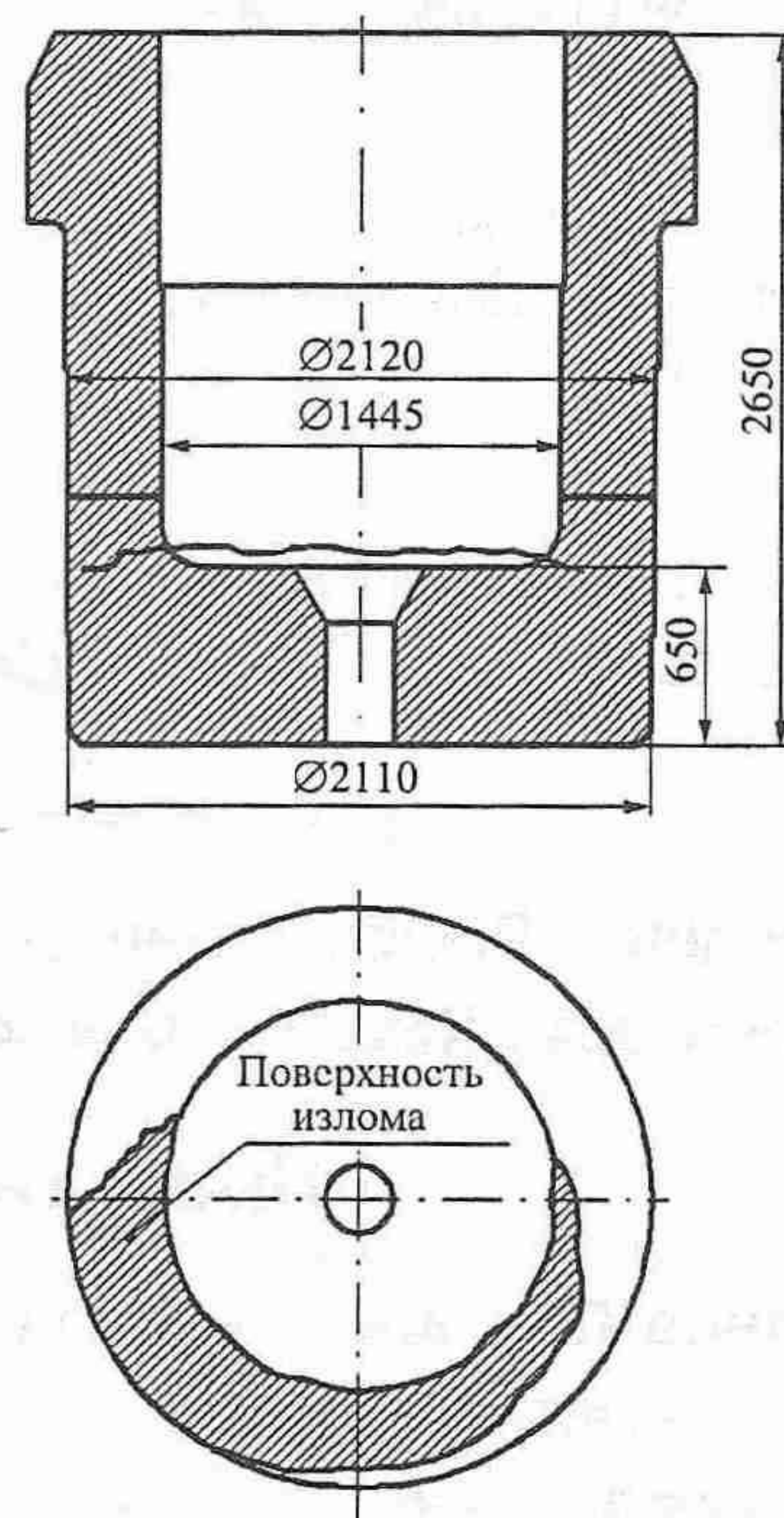
Рис. 1. Схема разрушения цилиндра пресса 50 МН
