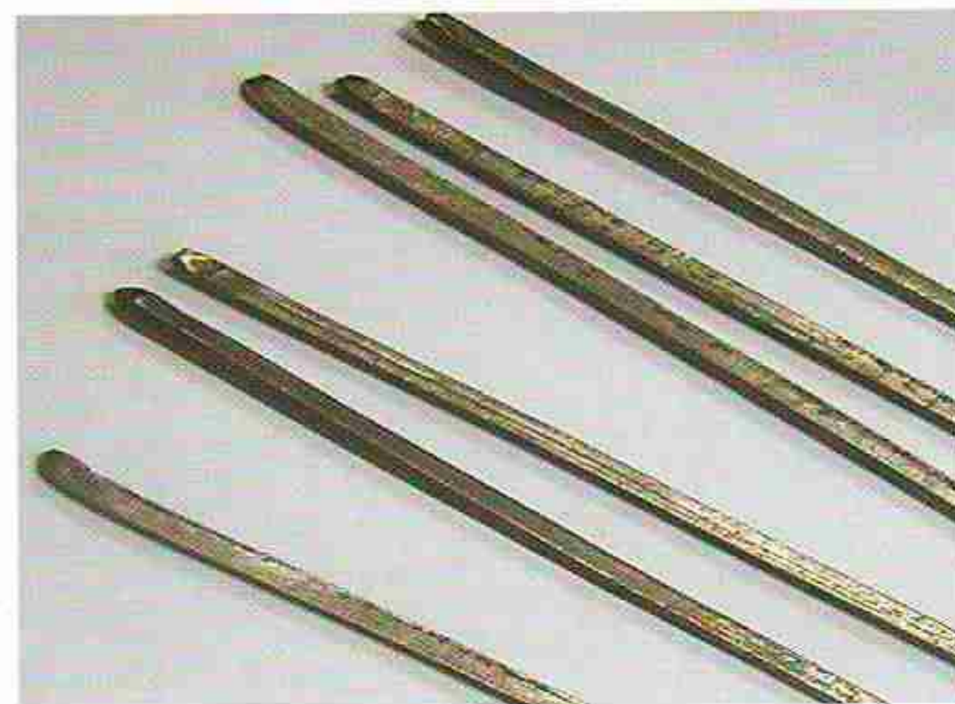
Рис. 4. Общий вид НС титановых длинномерных полуфабрикатов, полученных методом РКУП- conform при комнатной температуре (шесть циклов обработки)
