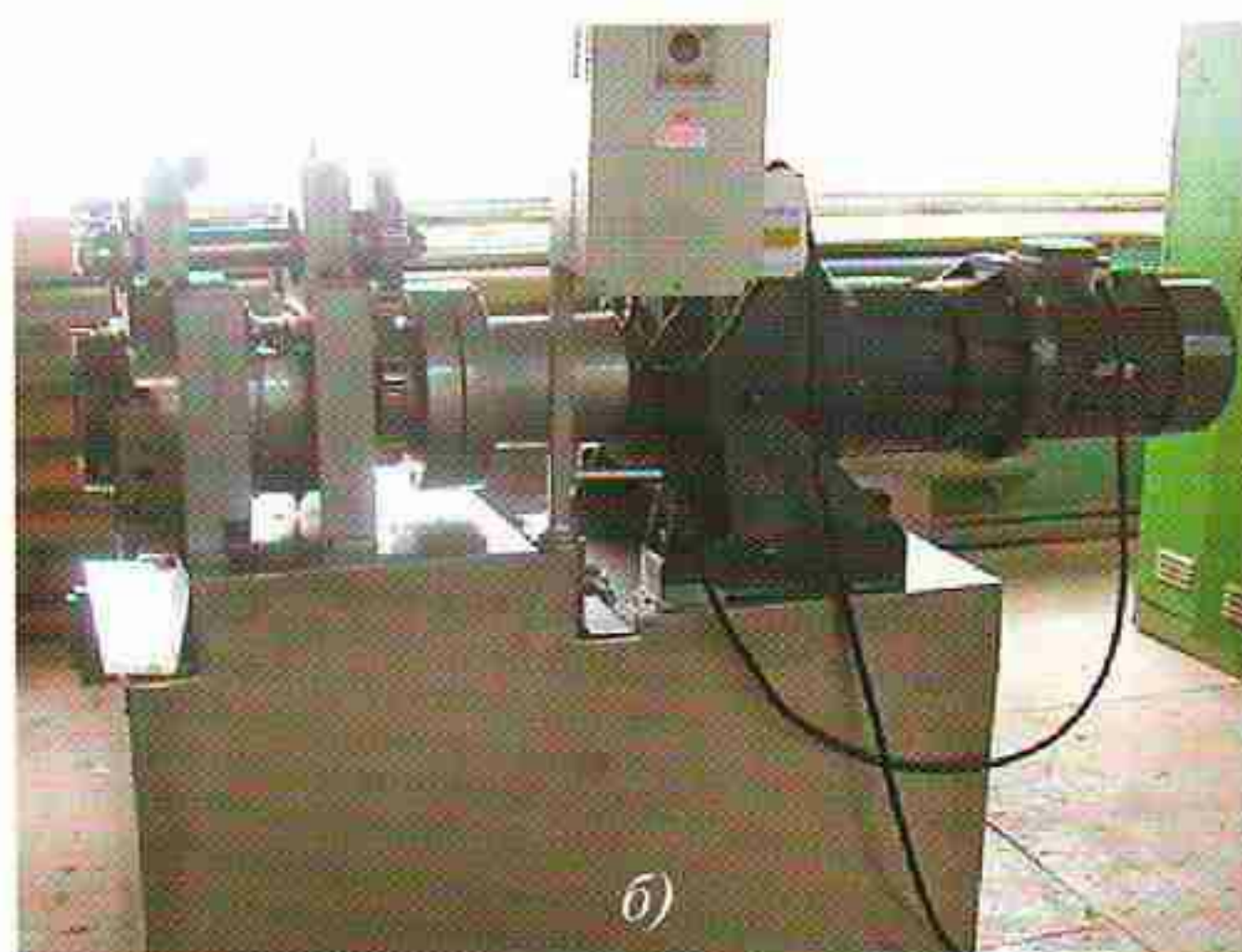
Рис. 2. Принципиальная схема процесса РКУП- conform (а) и общий вид экспериментальной установки (б)
