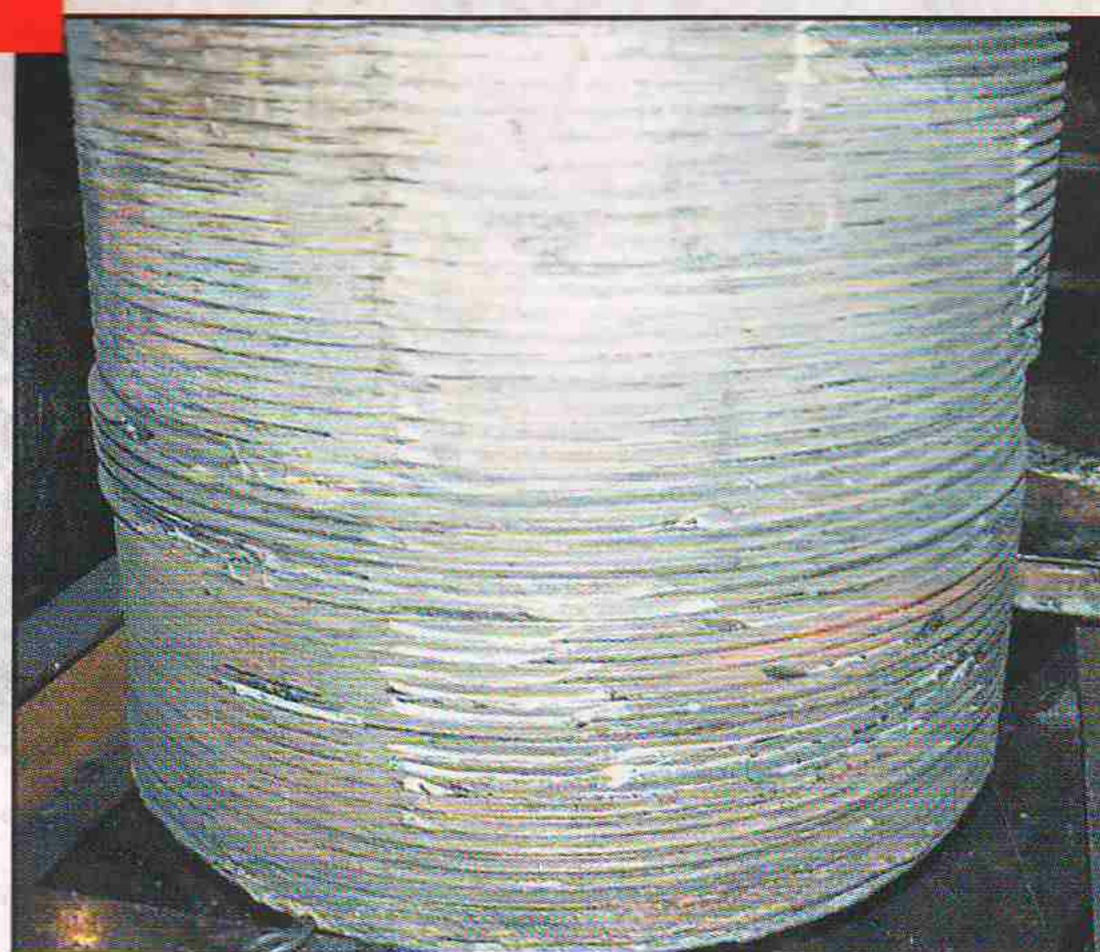
Разрушения внешней резьбы колонны под основанием пресса силой 100 МН (диаметр колонны 830 мм)
