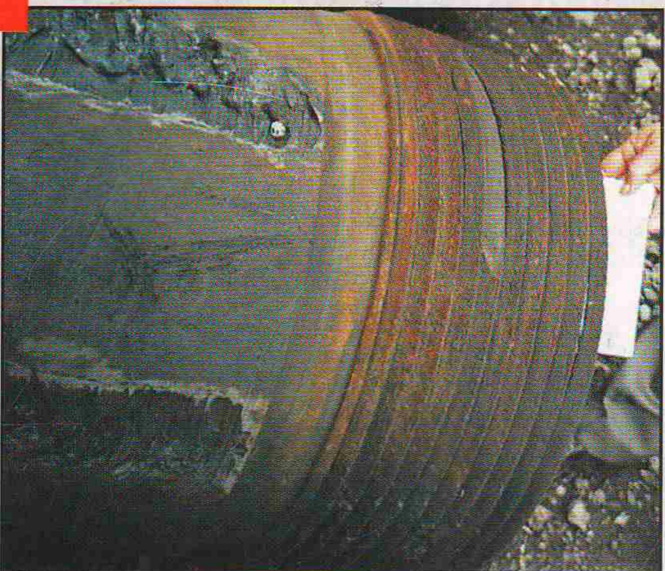
Срезанный виток резьбы на разрушенной колонне пресса силой 70 МН (диаметр колонны 630 мм)
