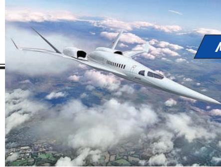
**Рис. 32. Проект сверхзвукового самолета с новыми формами корпуса для уменьшения шума во время преодоления звукового барьера**
