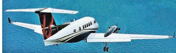
дальность (в перегоночном варианте на режиме наибольшей дальности) на расстояние 3460 морских миль (6408 км). Он также может развивать максимальную крейсерскую скорость 528 узлов (978 км/ч) и при максимальном взлетном весе 36 600 фунтов (16 601 кг) взлетать с ВПП длиной 5250 футов (1600 м).
