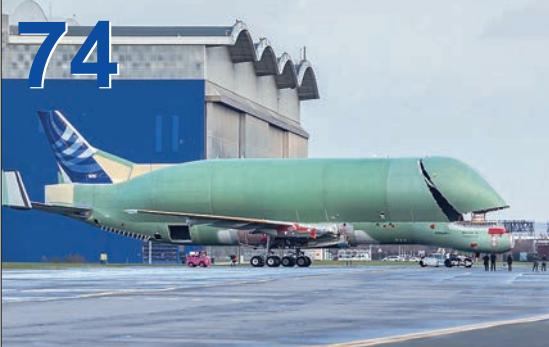
9 января 2018 г. в Тулузе состоялась выкатка нового грузового самолета Beluga XL, изготовленного на основе широкотелевого Airbus A330-200. Новые воздушные суда будут использоваться для транспортировки агрегатов и деталей самолетов между производственными центрами Airbus в Европе и к линиям окончательной сборки во Франции, Германии и Испании. Beluga XL сможет перевозить единовременно оба крыла самолета Airbus A350 (Beluga ST перевозит только одно крыло этого самолета).
