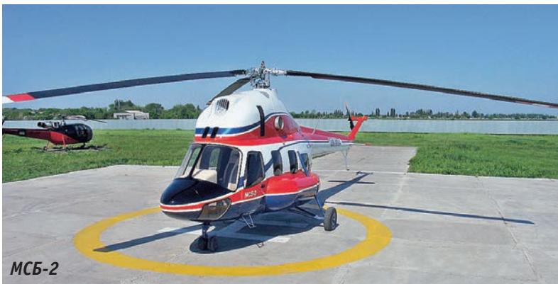
Вертолет Ми-2 с двигателями АИ-450М-Б может быть оборудован комплектом оборудования для экстренной медицинской эвакуации. Вертолет также может быть оснащен поисковым прожектором, лебедкой для быстрого подъема двух человек и другим целевым оборудованием.
