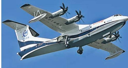
AG600 Jiaolong («Водяной дракон») имеет длину 39,3 м, размах крыла 39 м и максимальный взлетный вес 53 500 кг (по ряду китайских источников – до 60 т), что делает его самым большим современным гидросамолетом в мире. AG600 оснащен четырьмя турбовинтовыми двигателями (ТВД) WJ6 взлетной мощностью по 5100 л. с. с шестилопастными воздушными винтами.
