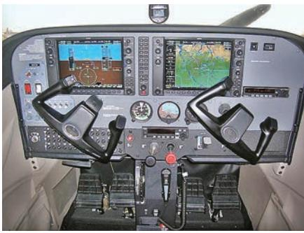
Рис. 15. «Стеклянная» кабина самолета Cessna-172
