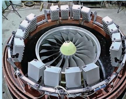
в вентилятор крупной птицы в критическое сечение лопатки и проверки удержания гильзы в пушке.
