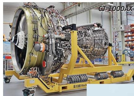
Двигатель имеет двухвальную схему, трехступенчатый компрессор низкого давления, 10-ступенчатый компрессор высокого давления и двухступенчатую турбину высокого давления. Топливные форсунки для кольцевой камеры сгорания создавались на 3D-принтере. Максимальный диаметр 1,95 м, длина 3,29 м. Планируется изготовить более 20 опытных экземпляров, эксплуатация серийных моторов – после 2021 г.
