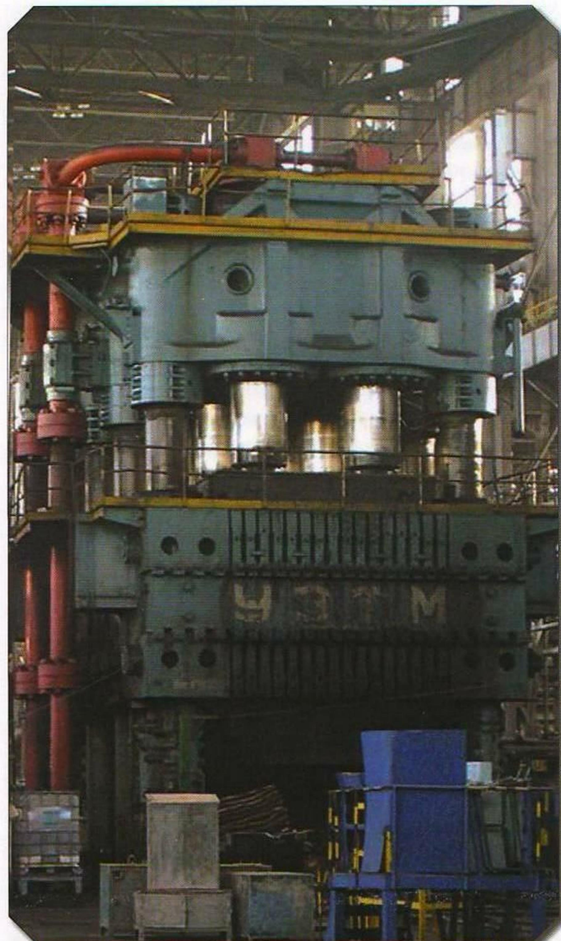
Рис. 1. Штамповочный пресс силой 300 МН конструкции УЗТМ
