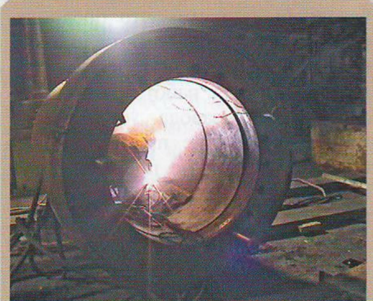
Рис. 4. Рабочий момент заварки трещины в галтели днища цилиндра силой 35 МН
