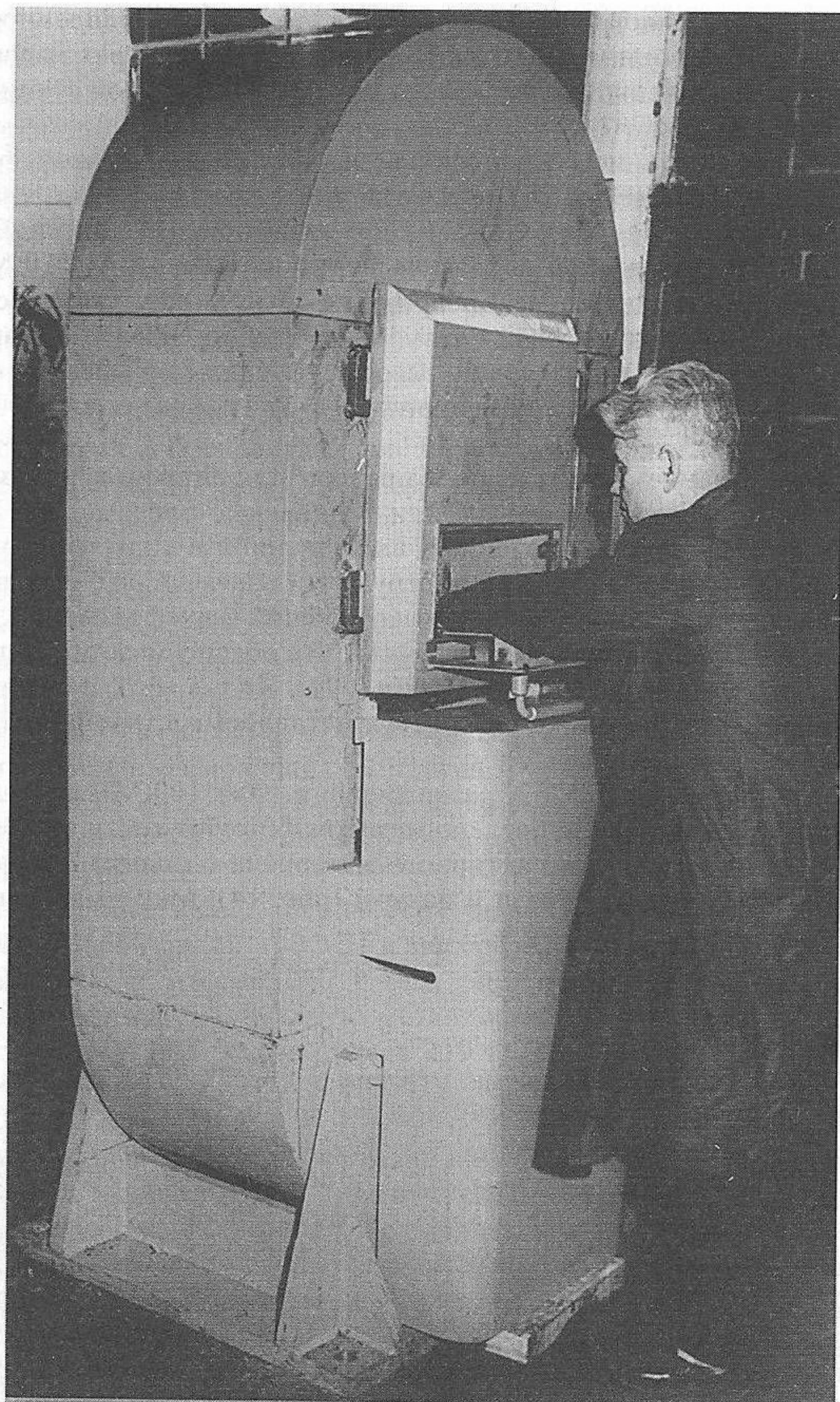
*Рис. 13.* Пресс Д0043 силой 20 МН для синтеза алмазов
