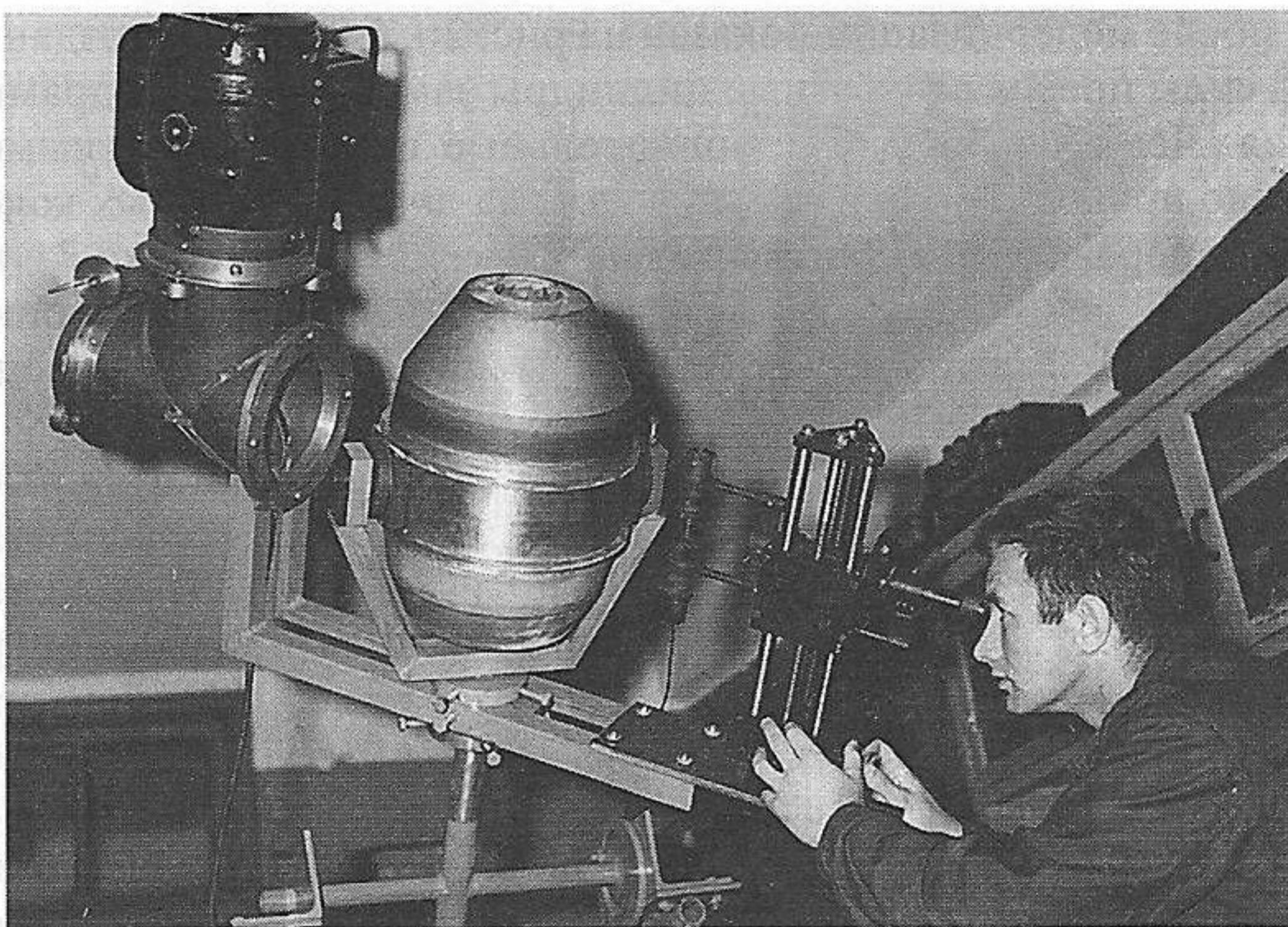
*Рис. 21.* Модель корпуса конвертера из оптически чувствительного материала с несущей средней частью в нагружочном устройстве
